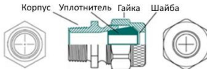
Кабельный ввод REMKE RSRS-206 имеет коническую резьбу  $\frac{3}{4}$  и выполнен из нержавеющей стали. Кабельный ввод обеспечивает герметизацию датчика нагрузки и его взрывозащищенность.
